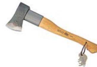
Spaltbeil für kleine bis mittlere Stücke. Die ballige Kopfform sorgt für hohe Spaltwirkung auch in hartem Holz. Die Schneide ist mittelscharf und leicht ballig geschliffen - für hohe Spaltenergie und lange Formbeständigkeit. Die Stielschutzhülse aus Stahl sorgt für zusätzliche Sicherheit und Langlebigkeit des Stieles.
